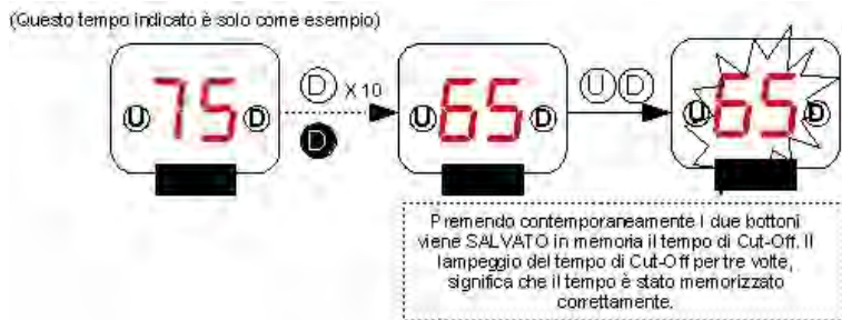
Figura 10: Esempio impostazione tempo di Cut-Off
