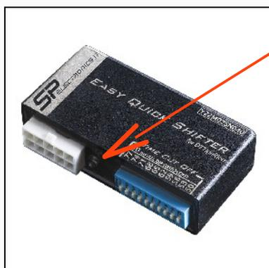
**Luce led Gialla :** All'accensione del veicolo, la luce di colore giallo si accende e si spegne velocemente come un flash, indicando che il dispositivo è in funzione. Poi si accende solamente quando viene attivato il sensore. Serve inoltre per effettuare il "TEST SENSORE (\*)".
